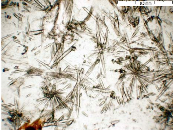
Foto 253 Sfěrolitické útvary wollastonitu . Raně středověká struska Sudice. PPL. Foto M. Gregerová.
