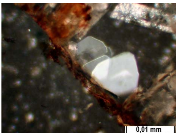
Foto 243 Tridymit v historickém sklářském odpadu – Slatiňany – sklo z doby bronzové. XPL. Foto M. Gregerová.
