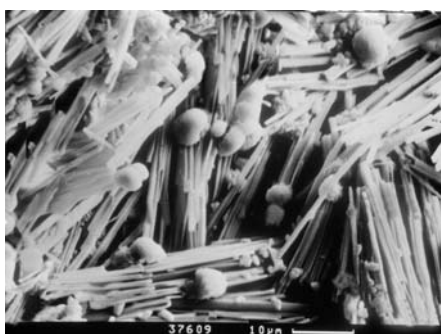
Foto 232 Thaumasitové agregáty v dutinách železobetonové desky Karlova mostu v Praze. Elektronový mikroskop CamScan. Foto P. Sulovský..
