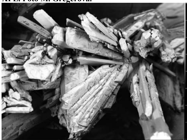
Foto 224 Krystalky sádrovce tvořících efflorescenty pískovcových kvádrů Karlova mostu v Praze. Cameca SX100. Foto R. Čopjaková.
