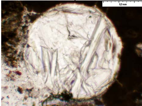
Foto 221 Sádrovec vedle ettringitu v betonu z Karlova mostu v Praze, konec 19. století. PPL. Foto M. Gregerová.
