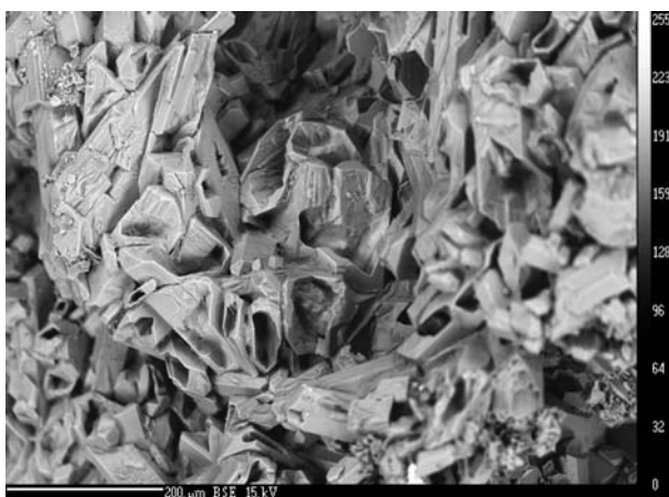
Foto 225 Koroze sádrovce eflorescentů pískovcových kvádrů v Praze (léto 2004). Cameca SX100. Foto R. Čopjaková.
