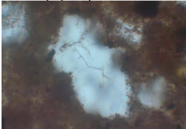
Foto 314 Portlandit ve struskobetonu. PPL. Foto M. Gregerová.
