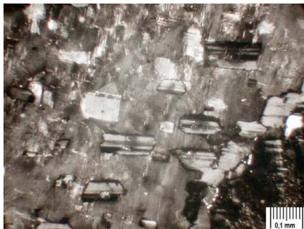
Foto 189 Alkalický živce – perthit. Tabulkovitý albit v ortoklasu. Kožlí u Ledče. XPL. Foto M. Gregerová.
