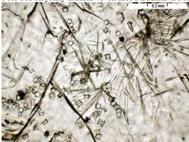
Foto 169 Krystaly mullitu ve sklovine. Podélné a příčné průřezy. PPL. Foto M. Gregerová.
