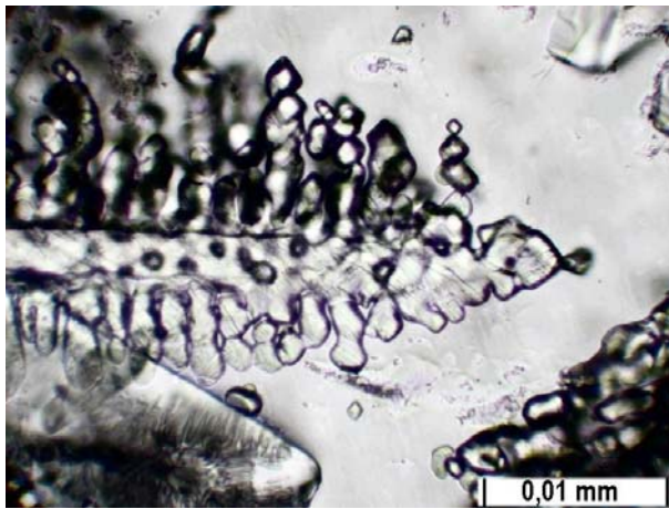
Foto 22 Stromečkovité (kostrovité) útvary baddeleyitu v corhartu. PPL. Foto M. Gregerová.
