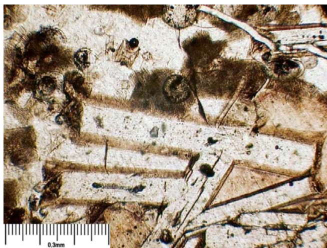
Foto 1 Ākermanit ve strusece z Nové huti Ostrava. PPL. Foto M. Gregerová.
